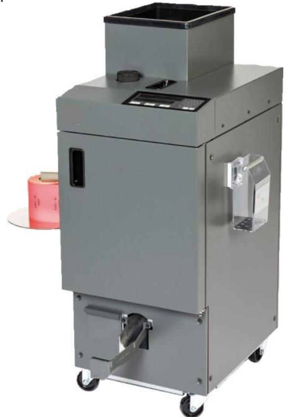
Das Verpackungsprinzip der LPC-2R, bei dem die Münzen über Spiralwalzen geführt werden, ist sicher, schnell und problemlos. Bei der Zählung kann zwischen Stück- und Rollenanzahl gewählt werden.
